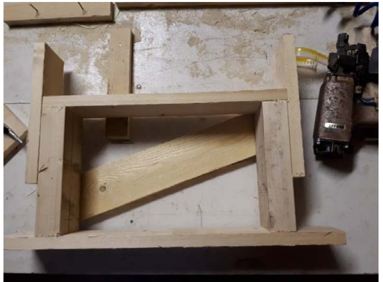
(3) Paja alkoi heti pyöriä. Kulkusiltojen jalkoja tehtiin useita kymmeniä, ehkei nyt sataa kappaletta kuitenkaan..
